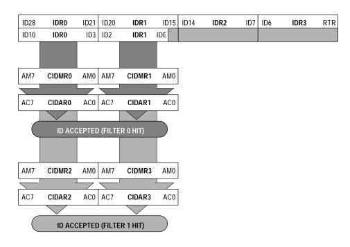
Figure 4. Dual 16-Bit Maskable Acceptance Filters
