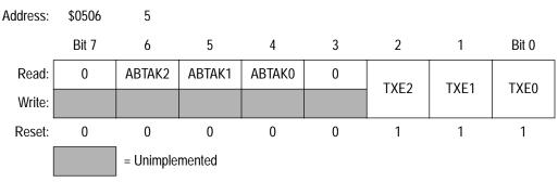
Figure 21. Transmitter Flag Register (CTFLG)
