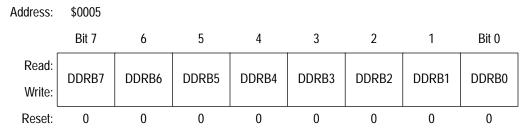
Figure 6. Data Direction Register B (DDRB)
