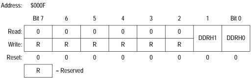
Figure 24. Data Direction Register H (DDRH)
